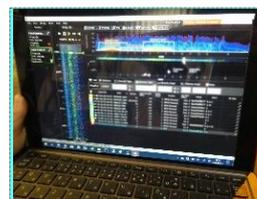
無線LANアナライザ (Wi-spy) を使用したサイトサーベイを実施。電波状態をリアルタイムに確認、電波の強さと発生源を特定して対策を立案します！
