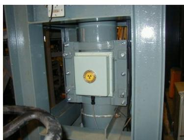
▲鋼管内の土砂の水分測定
